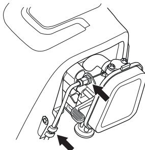
Отрегулируйте гайку на тросе газа с помощью гайки. Затем затяните стопорную гайку.
