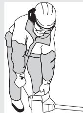
Всегда тяните шнур стартера под прямым углом. Вытягивание стартера не под прямым углом приведет к перетиранию шнура в петле. В результате трения возможен более быстрый износ шнура. Всегда удерживайте ручку стартера при возвращении шнура. Запрещается позволять шнруу произвольно возвращаться из вытянутого положения. Это может привести к заеданию шнура или его износу, а также повреждению узла стартера.
