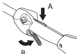
Проверьте, чтобы ручка газа в момент возвращения блокировочного рычага в
