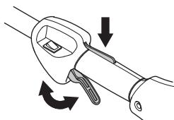
См. указания в разделе Запуск. Включите машину и полностью откройте дроссель. Отпустите рычаг дросселя и удостоверьтесь, что режущее оборудование останавливается и остается неподвижным. Если после постановки дросселя в положение холостого хода режущие оборудование продолжает вращаться, следует проверить регулировку холостого хода карбюратора. См. указания в разделе Техническое обслуживание.
