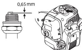
**ВНИМАНИЕ!** Всегда используйте только указанный тип свечи! Применение несоответствующей модели может привести к серьезным повреждениям поршня/цилиндра. Следите за тем, чтобы свеча была оснащена т.н. изоляцией радиопомех.
